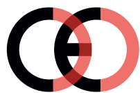
Falsk CE-mærke (for tæt på hinanden)
